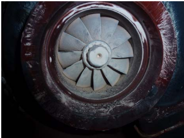
Ablagerungen am Abgasturbolader
